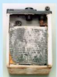
サルフェーションで劣化したバッテリー
